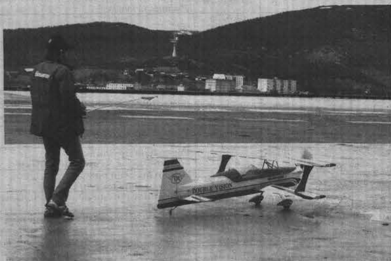
Размах крыльев такого самолета достигает 2,5 метра, вес 13 кг, двигатель бензиновый 50 см 3 , как у мопеда.
