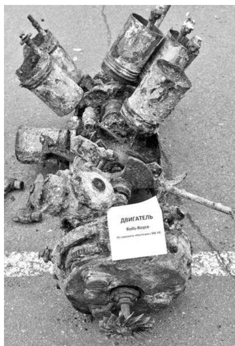
Двигатель «Роллс-Ройс» от самолета «Харрикейн» МК-IV.
