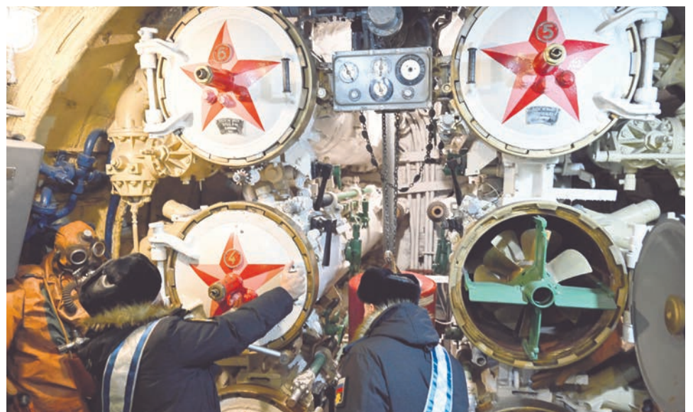
Первый отсек К-21 — торпедный, здесь расположены 6 торпедных аппаратов. При аварийной ситуации через них возможен выход с подлодки.
