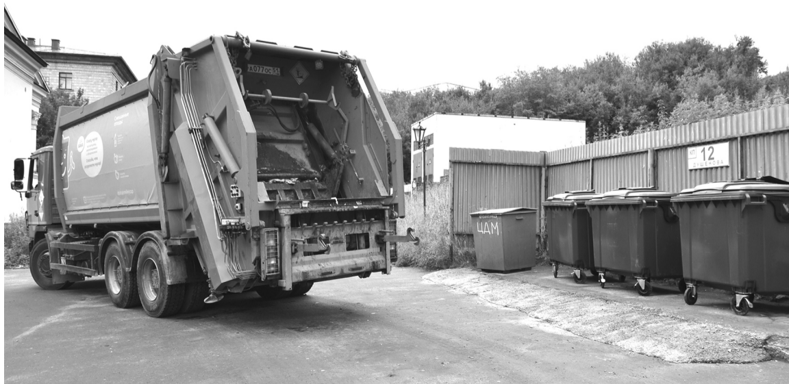
Мусоровоз задней загрузки для контейнеров нового образца хорошо показал себя в деле.
