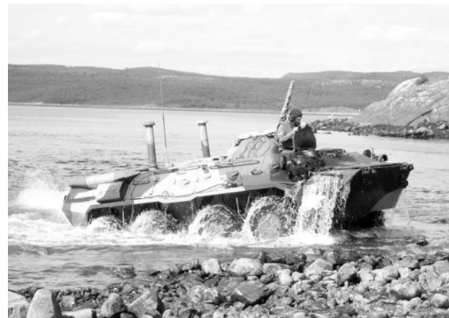
БТР-80 может двигаться по воде со скоростью до 9 км/ч.
