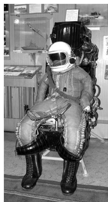
Комплекс средств спасения и жизнеобеспечения: катапультное кресло (установка К-86) и защитное снаряжение летчика.
