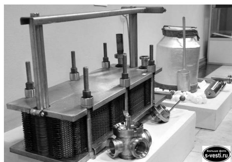
Ретрооборудование: теплообменная установка для охлаждения молока; трехходовой пробковый кран; молочный бидон, из которого ранее фасовалась готовая продукция.
