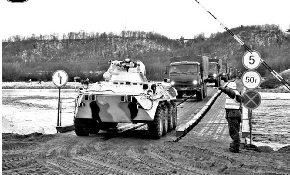
БТР-80 возглавил колонну из шести КамАЗов, загруженных до предела для испытания прочности временной переправы.
